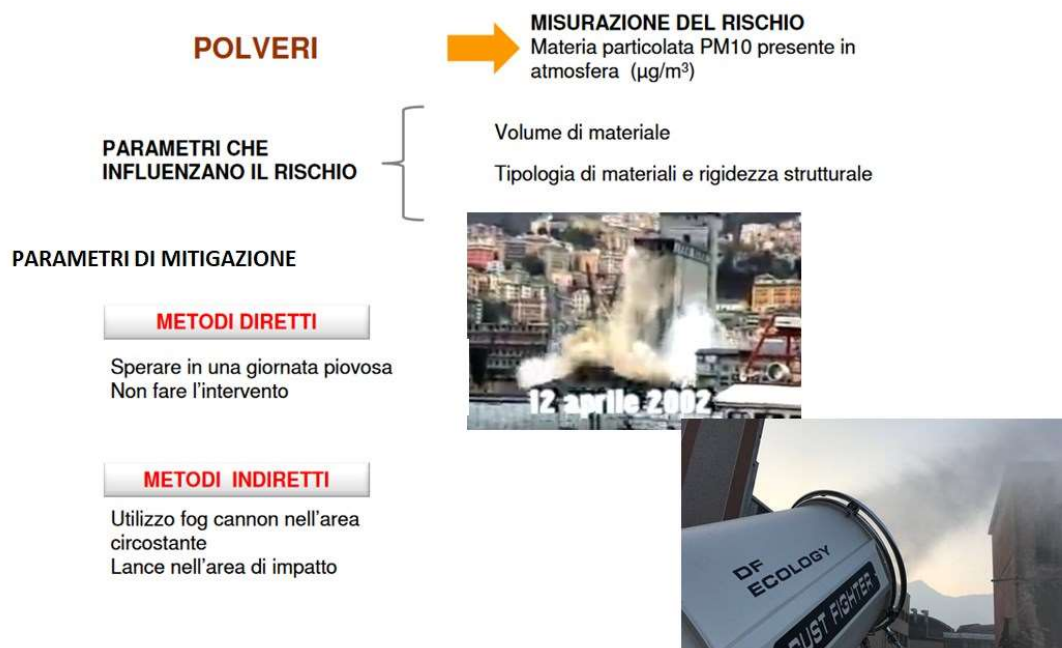
Figura 16 | Getto di acqua nebulizzata mediante cannon fog
